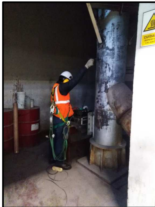
Fotos N°03 y N°04: Vista de Medición de Emisiones Atmosféricas en chimeneas de Caldera Fulton (izquierda) y Calentador de aceite Geka (derecha)
